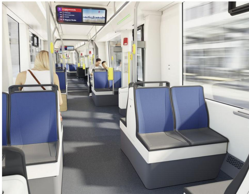
Ein geräumiger Wagenkasten mit 2+2-Bestuhlung, breiten Gängen und ohne Stufen, trotz Drehgestelltechnik.
